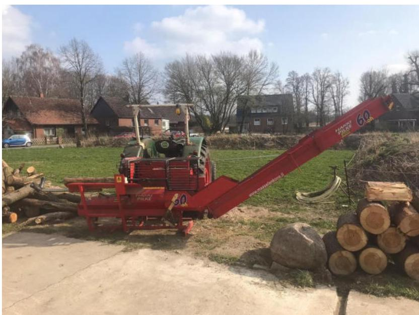
Abbildung 2: Traktoraufsatz mit Säge-Holzspalter
