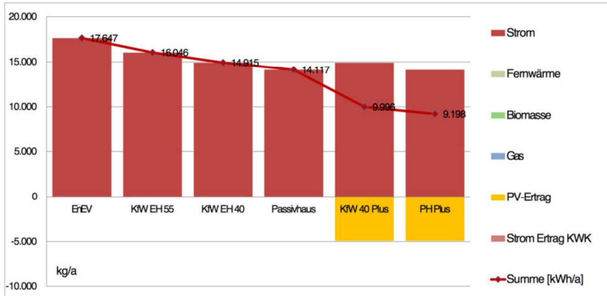
Abb. 19: CO<sub>2</sub>-Emissionen für Typ A mit Luft-Wasser-Wärmepumpe
