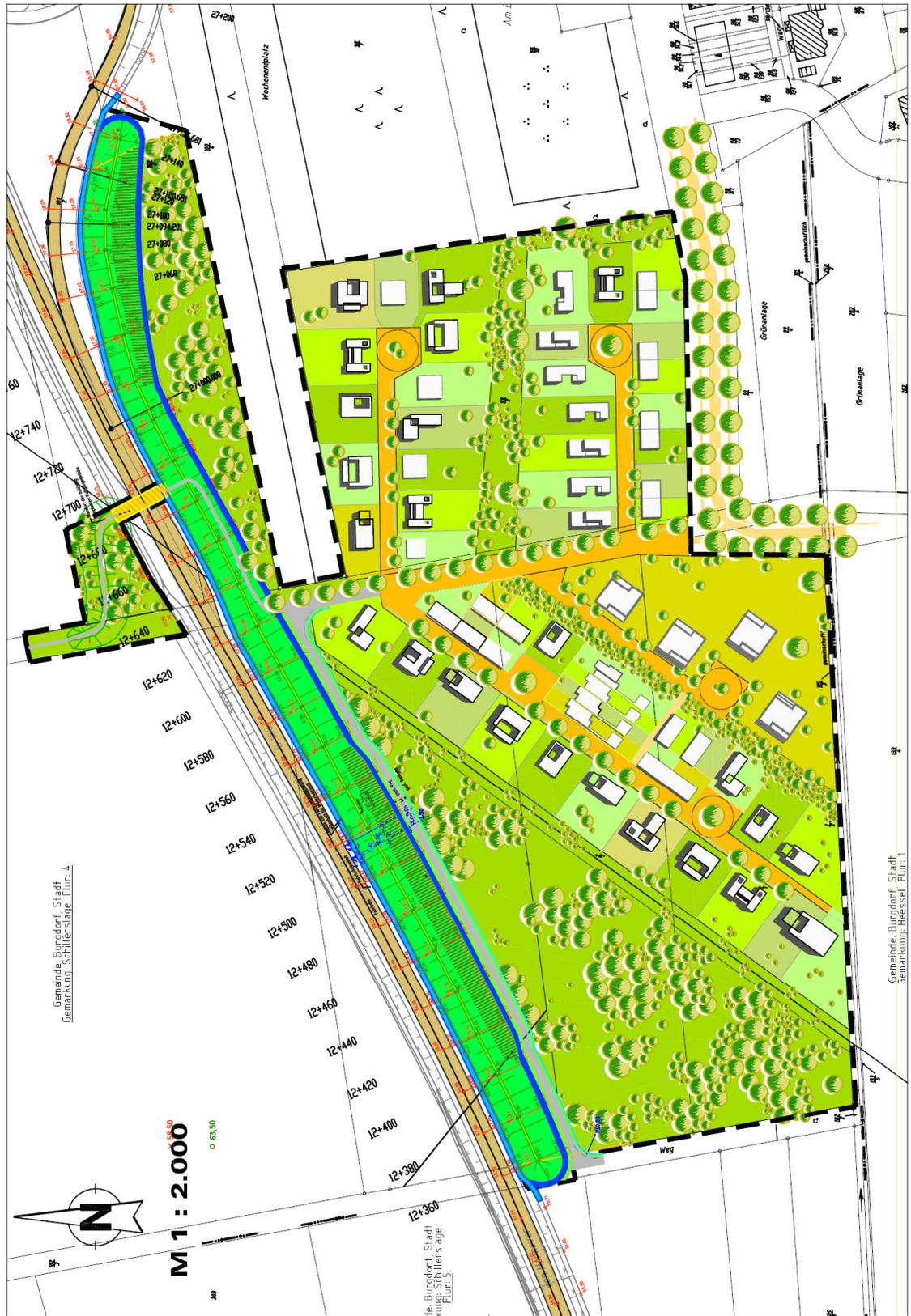
Abbildung 5: Maßnahmenplan (Flächendarstellung zur Eingriffs-Ausgleichs-Bilanzierung)
