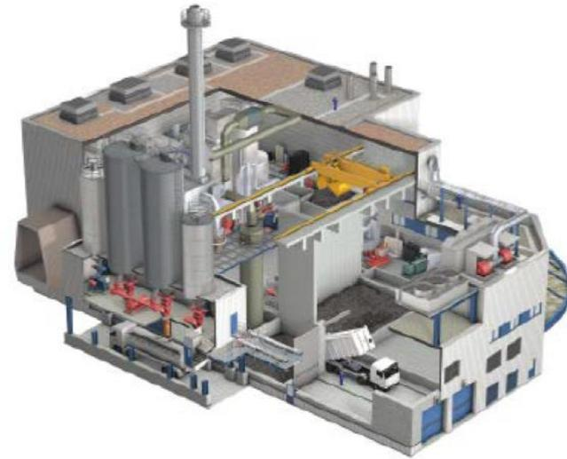
Abb. 4: Schnittzeichnung einer vergleichbaren thermischen Klärschlammverwertungsanlage
