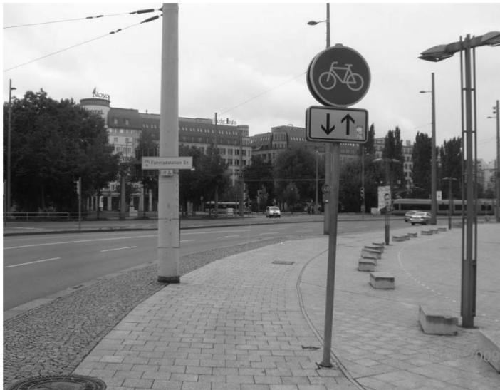
Abb. 5: Beschilderung eines benutzungspflichtigen Radweges im Zweirichtungsverkehr mit Zusatzzeichen 1000-31 StVO (Leipzig)
